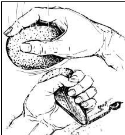
Fig. 17. Al fijar con la mano izquierda el cincel, las líneas serán más precisas.
